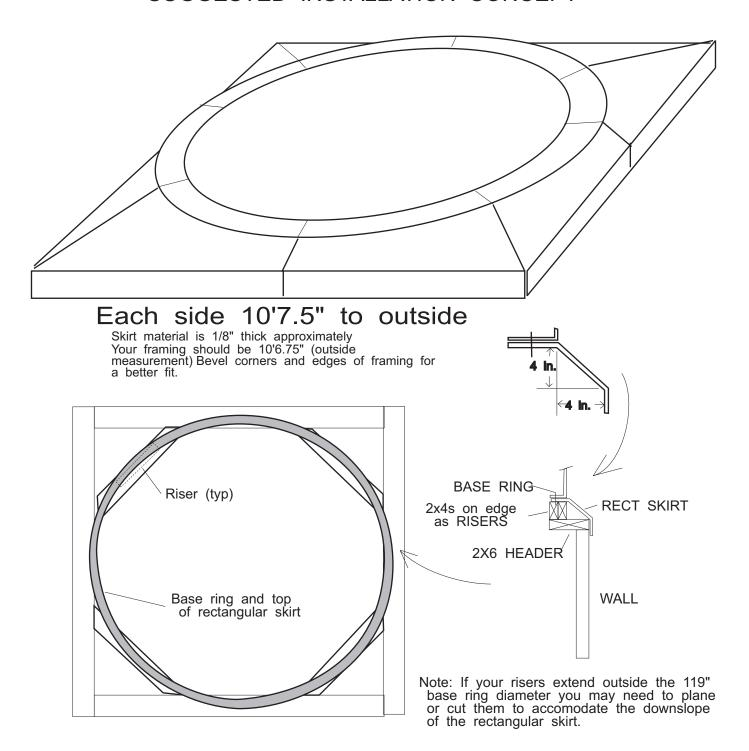
STRUCTURAL FRAME SUPPORTS SKIRT, BASE RING, & DOME
